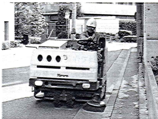
写真-6 路面を清掃するスーパー
