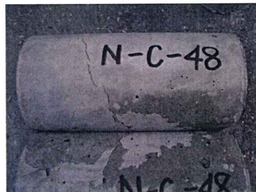
写真-1 日なた保管で生じたひび割れ
