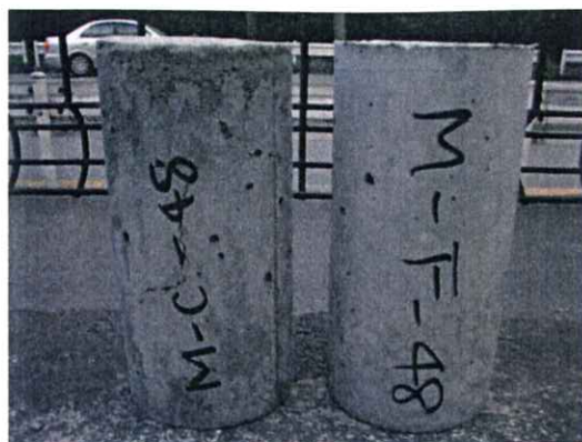
写真-2 上面シールの有無による供試体表面の比較（左：上面シール無し、右：上面シール有り）どちらも日なたで2日間保管
